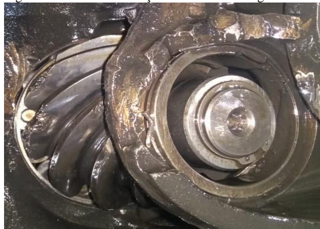
Figura 3: Rolamento e berço do diferencial desgastados.
