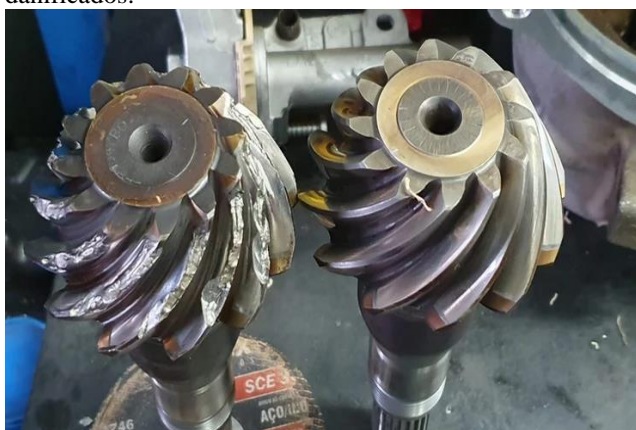
Figura 2: À esquerda, pinhão do eixo diferencial com dentes danificados.
